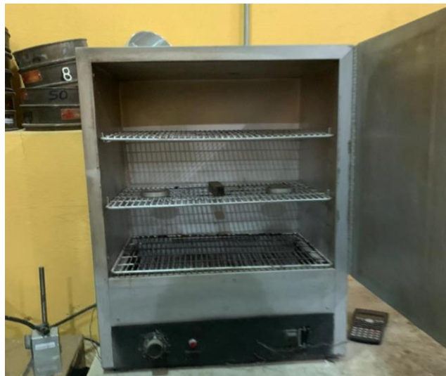
Figura 51: Se meten 3 pruebas al horno por 24 hrs
