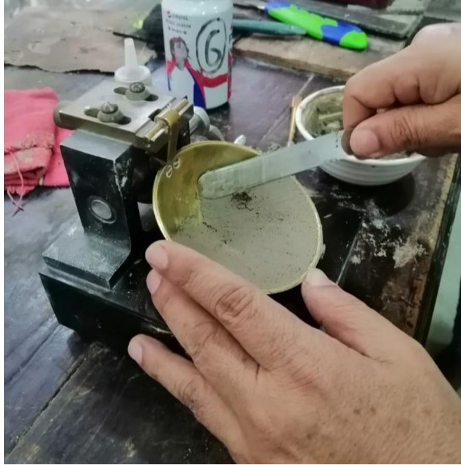
Figura 49: se coloca material remojado en copa curva grande y se le hace una línea en medio
