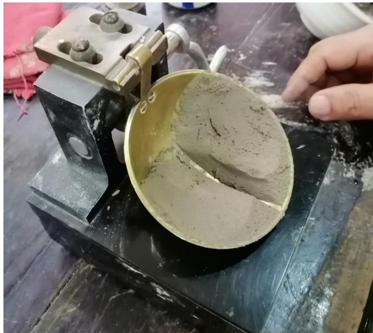
Figura 50 :Se le da 25 golpes para ver si la división se junta
