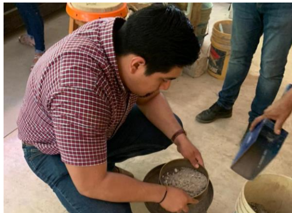
Figura 46: Se criba el material en la malla #40
