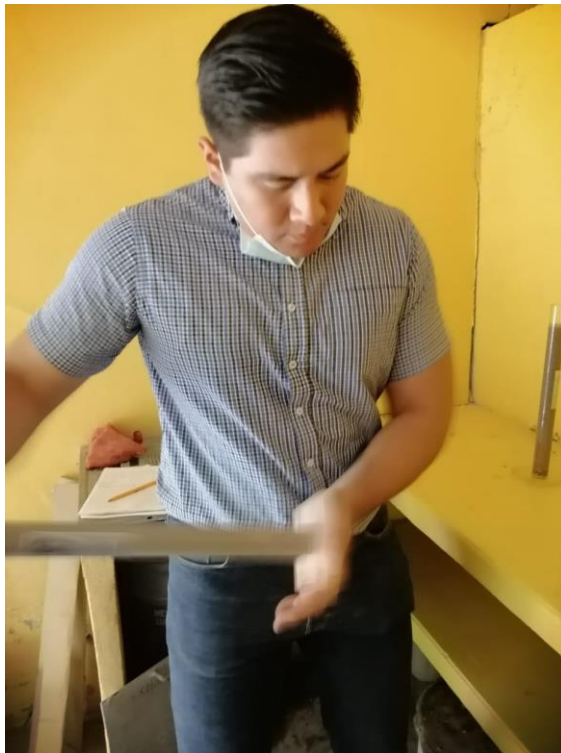
Figura 52: Agitado de probeta para equivalente de arena
