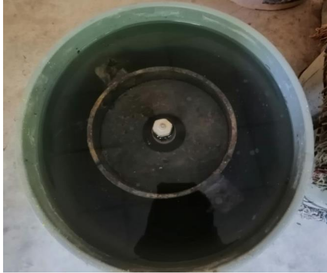
Figura 45: Se mete el material compactado por 72 hrs
