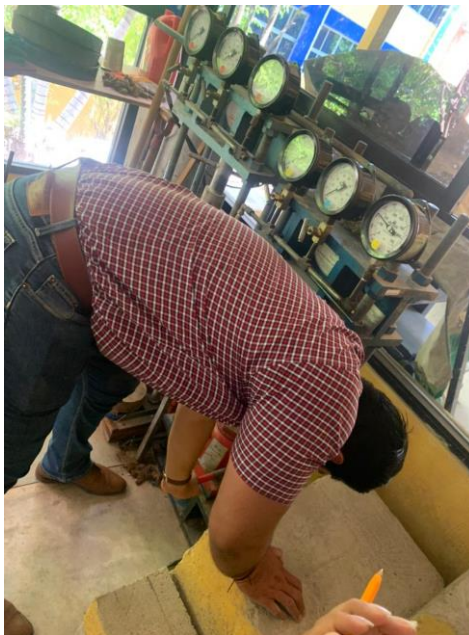
Figura 43: Colocación del molde en la prensa para compactar el material
