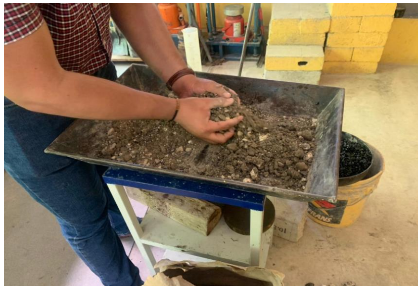
Figura 41: Humedecimiento del material
