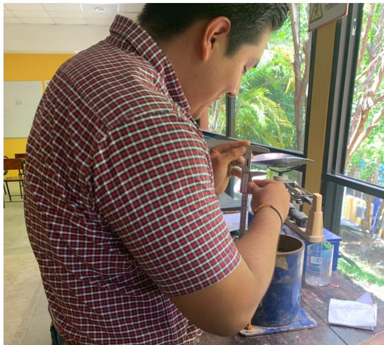
Figura 44: se toma la medida con el vernier para sacar una altura promedio
