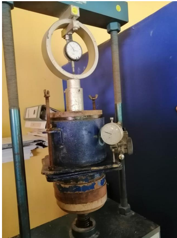
Figura 48: Colocación de la muestra en la prensa de penetración
