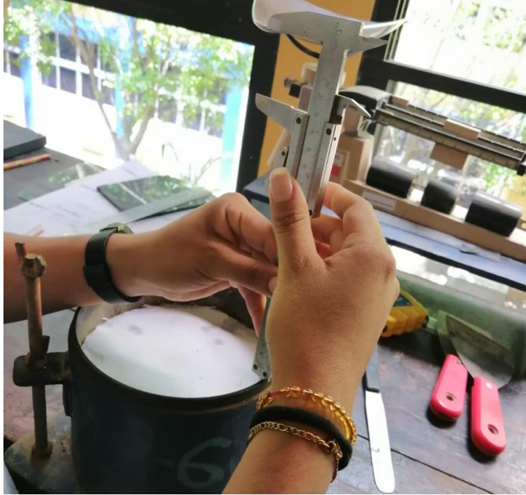
Figura 47: Se quita el collarín y se mide nuevamente con el vernier
