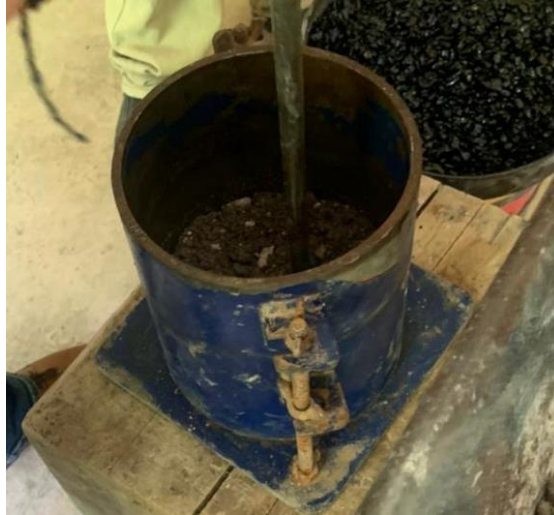
Figura 42: Colocación de 4 kg en un molde
