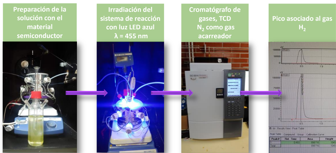
Figura 22. Proceso de evaluación fotocatalítica para la producción de H 2 de los materiales sintetizados (g-C 3 N 4 modificados, CdS y las heterouniones CdS/g-C 3 N 4 ).
