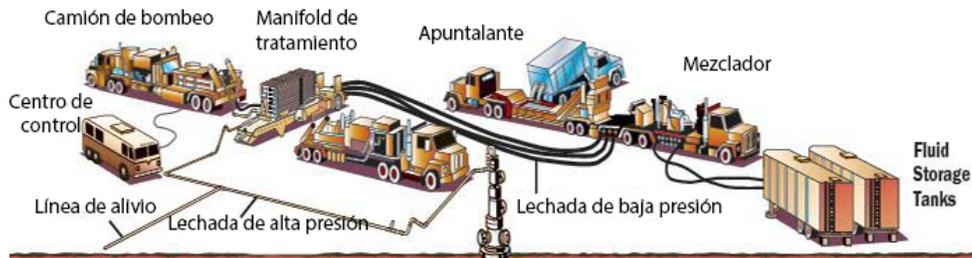
Figura 1.30: Esquema del equipo superficial en una operación de fracturamiento hidráulico.
