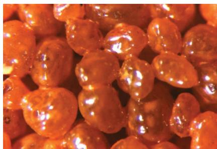
Figura 1.25: Arena curable de recubrimiento de resina que ha sido curada elevándola a altas temperaturas y esfuerzos para proveer enlaces de grano a grano y consolidación del paquete de apuntalante.<sup>35</sup>
