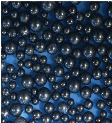
Figura 1.27: Apuntalante hecho de nanocompuestos termoplásticos<sup>35</sup> ( $\gamma_{prop} = 1.50$ )
