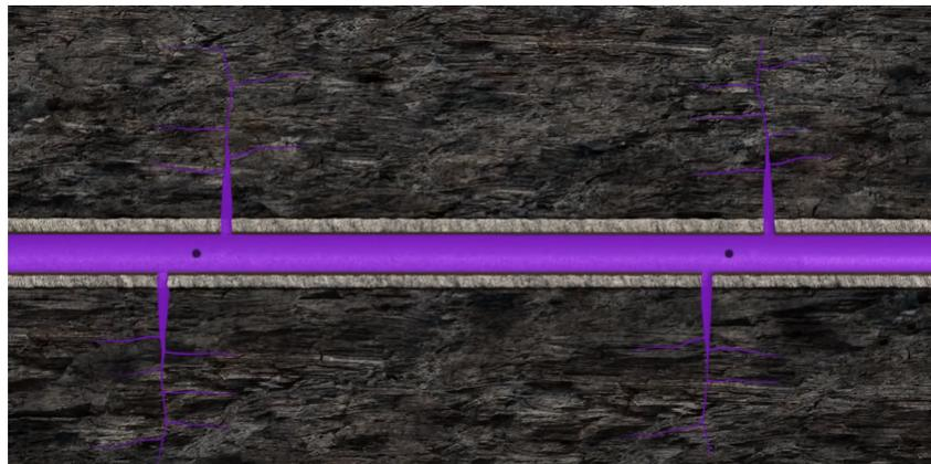
Figura 1.17: Etapas posteriores en la terminación Plug and Perf<sup>79</sup>
