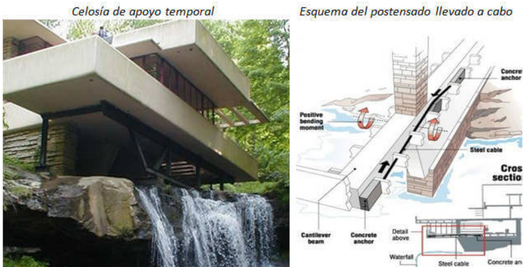
Imagen 24.0 Refuerzo estructural en la casa de la cascada; imagen en donde se demuestra la restructuración que se tuvo que hacer por riesgo de colapso. Garay, Álvaro. La casa de la cascada, la importancia del fallo II. Fuente https://failures.wikispaces.com/Fallingwater .
