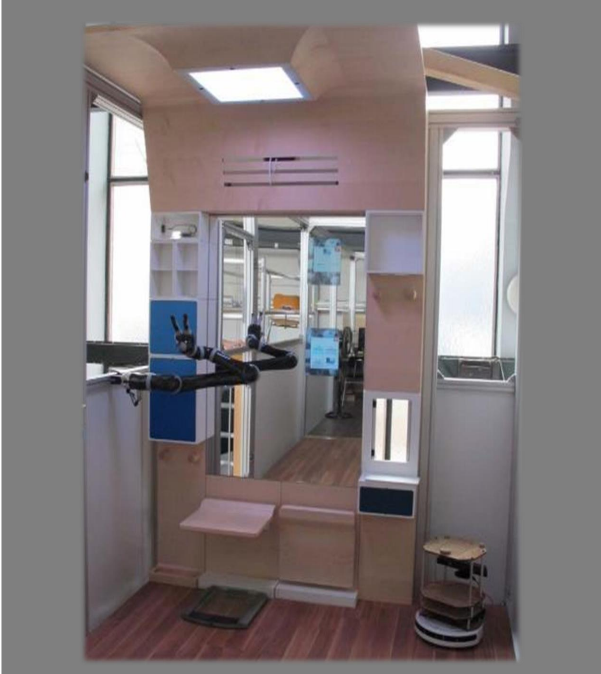
Ilustración 5.9 Brazo robótico intuitivo integrado a la piel robótica. Fuente: Br2 (Chair of Building Realisation and Robotics, 2001)
