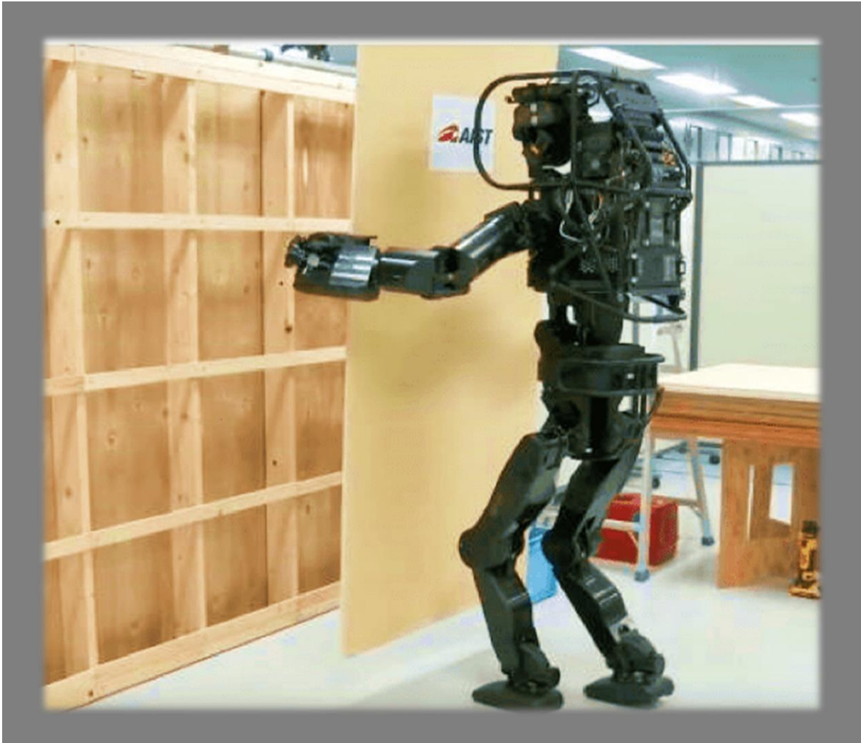
Ilustración 3.23 HRP-5P Robot, aplicando yeso cartón sobre entramado liviano de madera. Fuente: Revista Polo madera, AIST. Zilic et al. (2019).
