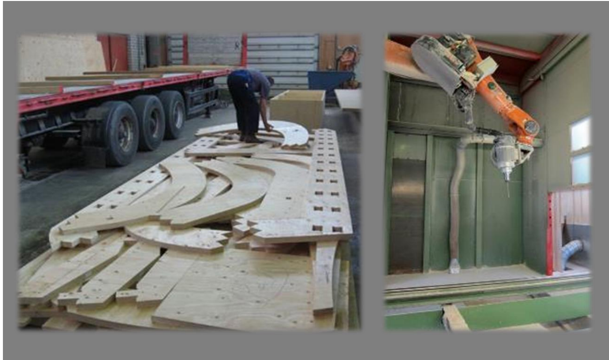
Ilustración 3.30 Derecha: Robot de corte en madera marca KUKA de la empresa Finnforest Merk . Izquierda: Piezas salidas del corte. Fuente: Archivo personal.
