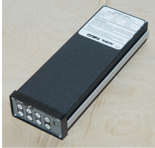
Figura 2.9: Acondicionador de señal para el LVDT.
