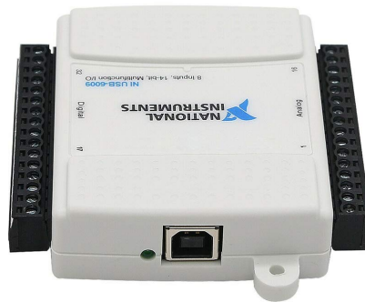
Figura 2.8: Tarjeta de adquisición de datos NIDAQ-USB-6009.
