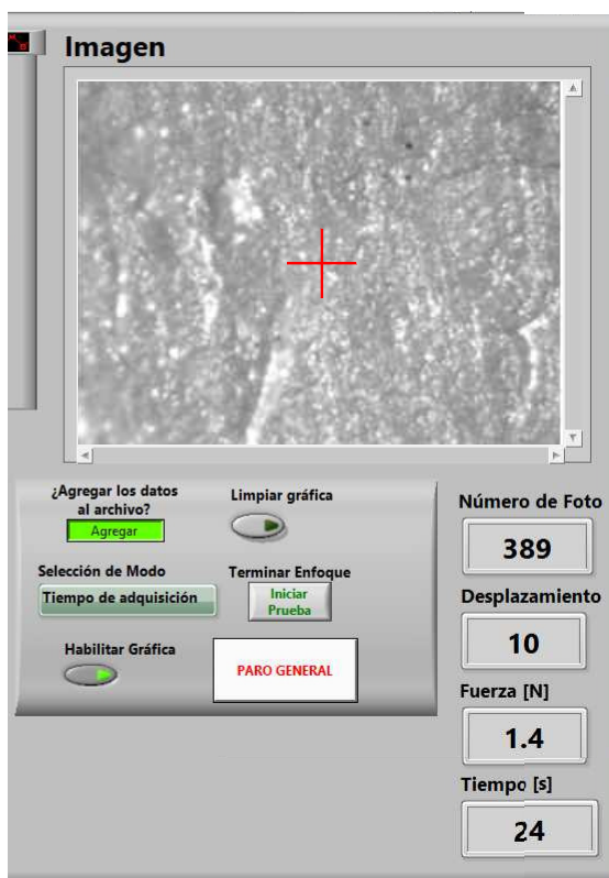
Figura 3.9: La columna derecha del panel frontal muestra la imagen capturada, datos del experimento como número de foto, desplazamiento, fuerza y tiempo, botones para almacenar datos, limpiar la gráfica y paro de emergencia.
