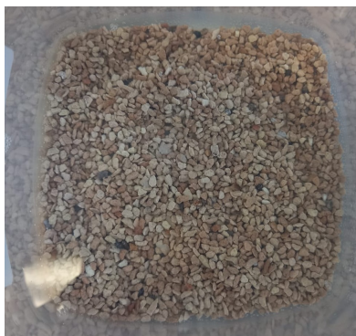
Figura 5.1: Zeolita tamizada y sumergida en agua destilada.
