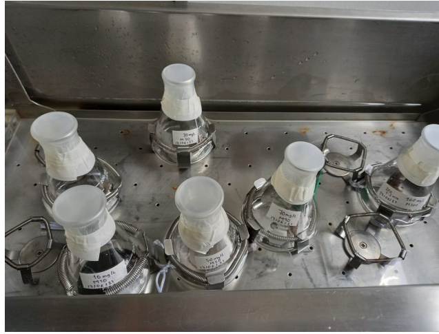
Figura 5.2: Experimentos de equilibrio: matraces con 50 mL de solución y 0.5 g de zeolita (T:22 °C, agitación: 200 rpm, diámetro de partícula: 1–3 mm, concentración inicial de amonio: 10–100 mgN–NH 4 + /L).
