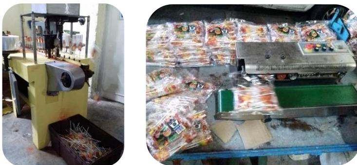
Fig. 3 Máquina envoladora automática (izq) y máquina selladora (der). Fuente: Elaboración propia.
