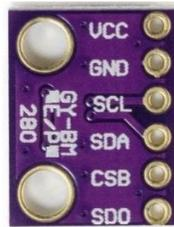
Ilustración 103: Pinout del sensor BMP280
