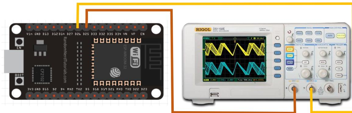
Ilustración 64: Diagrama de conexión del ESP32 a un osciloscopio
