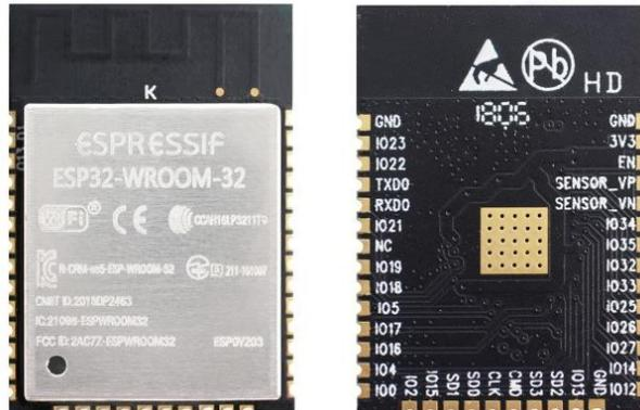
Ilustración 4: Módulo ESP32-WROOM-32
