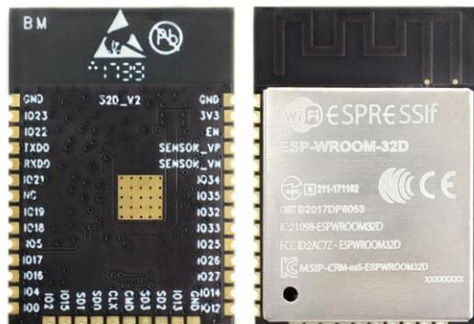
Ilustración 3: Módulo ESP32-WROOM-32D
