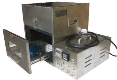
Figura 3.12 Cámara UV de ozono con sustrato calentador para la limpieza de todo tipo de sustratos.
