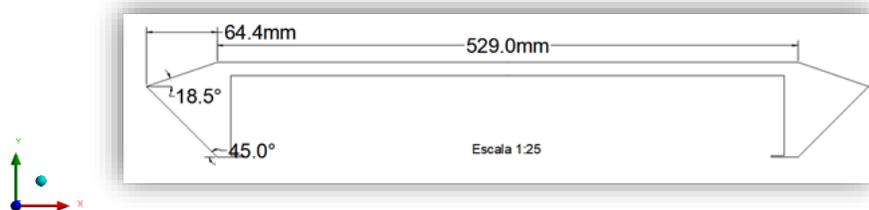
**Figura 7-5. Sección transversal del puente “La Concordia”, Aeroestabilizador 4**
