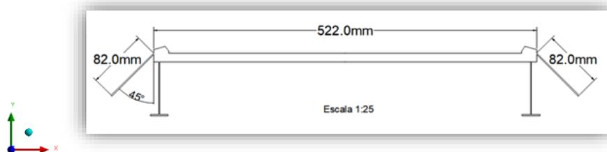
**Figura 7-6. Sección transversal del puente “La Concordia”, Aeroestabilizador 5**
