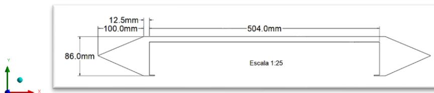
Figura 7-2. Sección transversal del puente “La Concordia”, Aeroestabilizador 1
