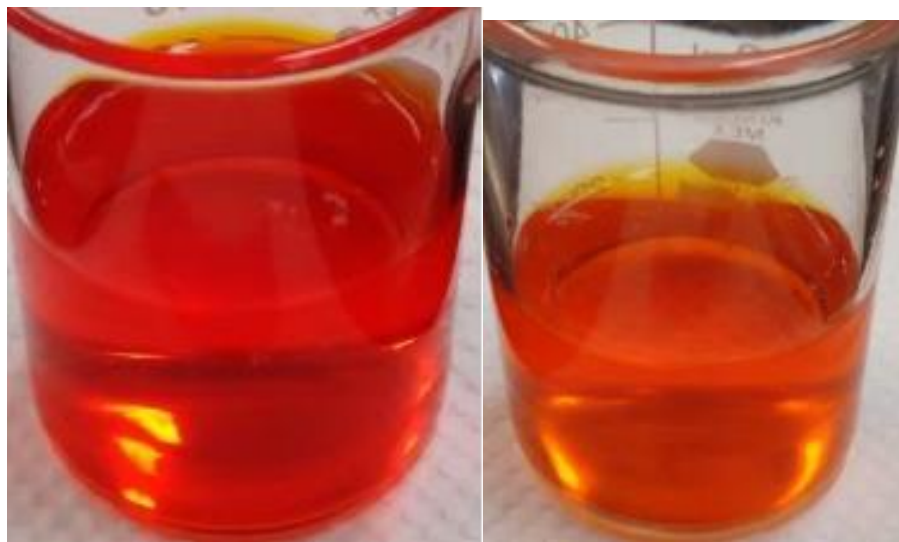
Figura 27.3. Resultados de la muestra cuya concentración inicial de AM fue 500 mg/L antes y después de ser tratada con 1 g de escoria M1 por 17 horas (Remoción 66.5 %).
