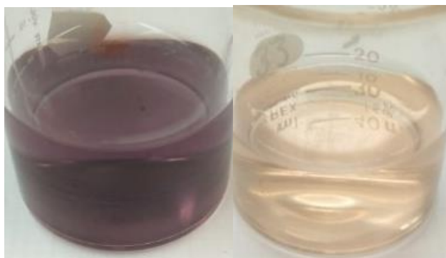
Figura 23.3. Resultados de la muestra cuya concentración inicial de NET fue 100 mg/L antes y después de ser tratada con 1 g de escoria M1 por 1 hora (Remoción 52 %).
