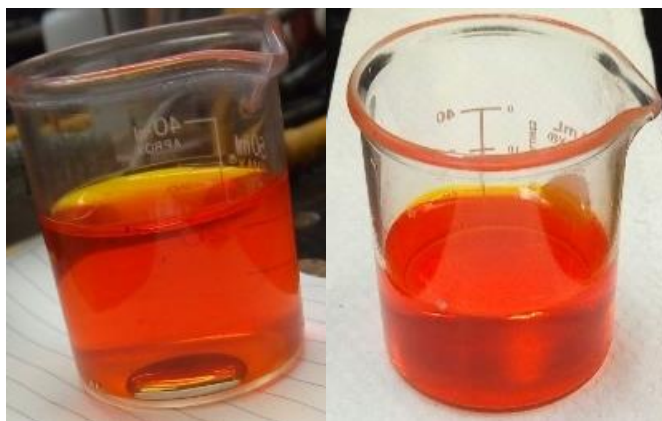
Figura 25.3. Resultados de la muestra cuya concentración inicial de RM fue 100 mg/L antes y después de ser tratada con 1 g de escoria M1 por 17 horas (Remoción 20 %).
