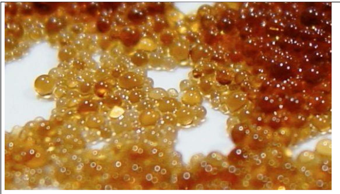
*Figura 3.11 Resina catiónica utilizada para la eliminación de dureza en el agua. (Novo Agua SA de CV, 2021)*
