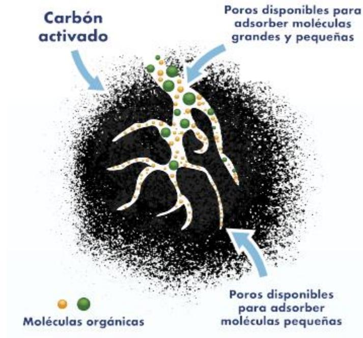
*Figura 3.10 Mecanismo de adsorción de carbón activado (Lainco, S.A., 2021)*
