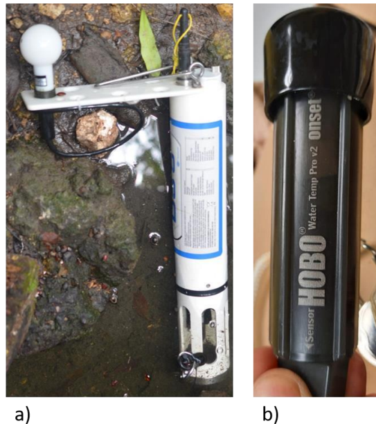
Figura 7. Sensores empleados para toma de datos fisicoquímicos. a) Hydrolab b) HOBO colocado en capa de agua marina.
