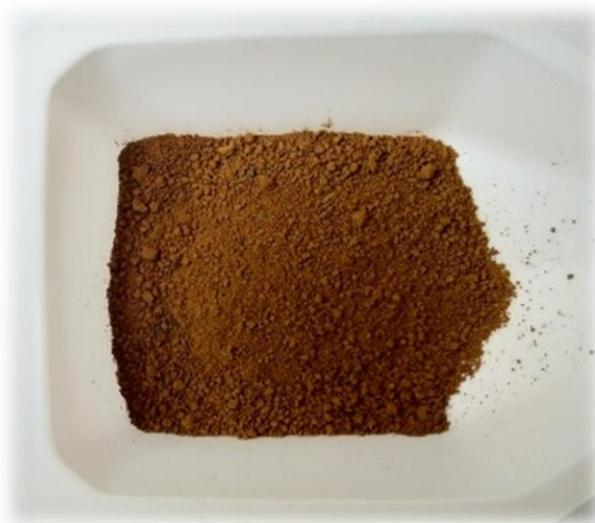
Figura 10. Minerales recuperados de los efluentes del acero inoxidable
