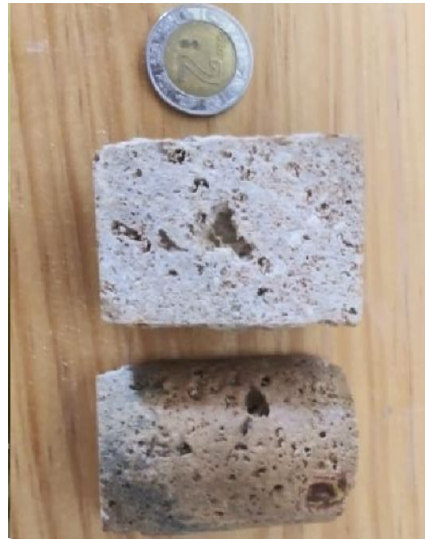
Figura 6.2. Corte longitudinal a la muestra de roca para inducir la fractura
