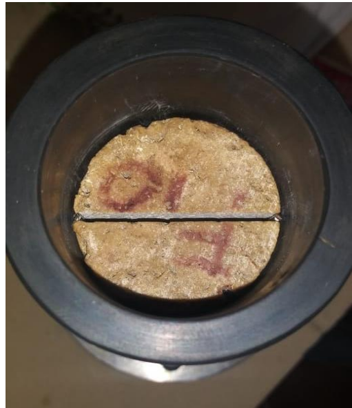
Figura 6.5. Muestra de roca (núcleo) en porta-núcleo con fractura longitudinal inducida
