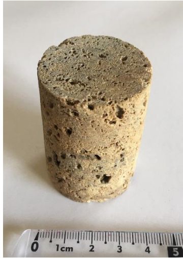
Figura 6.1. Muestras de núcleo utilizadas para medir el factor de recuperación de aceite por inyección de agua en presencia de PPG
