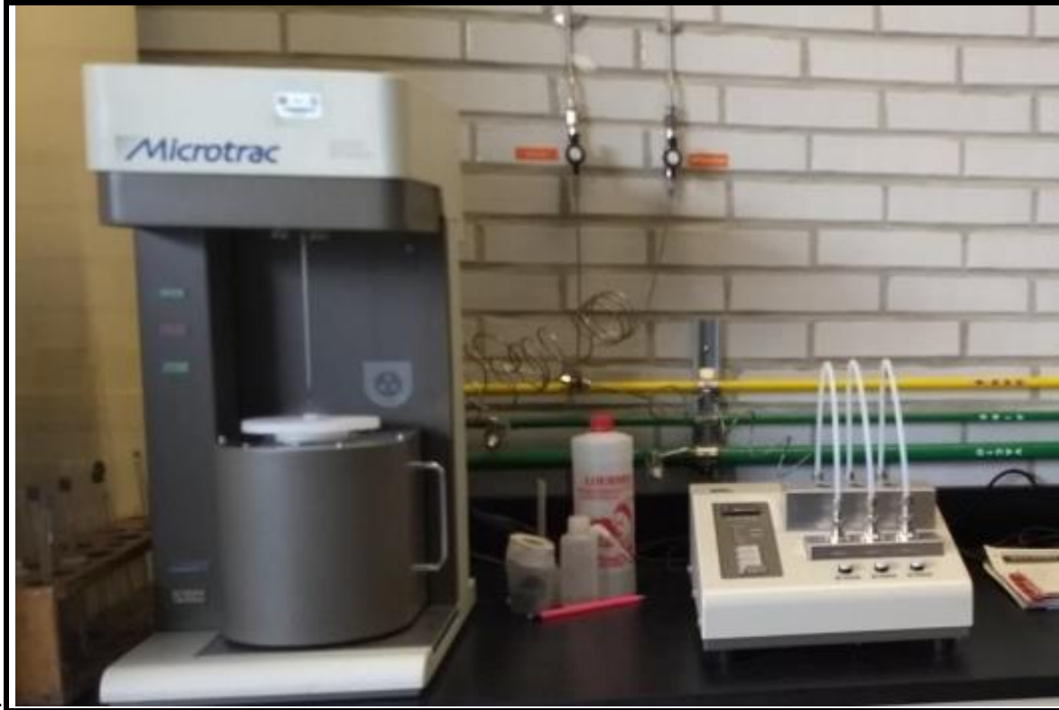
Fotografía 11 Equipo de Propiedades Texturales, de la Marca Bell Japan y desgasificador utilizando Helio molecular y Nitrógeno como adsorbato.
