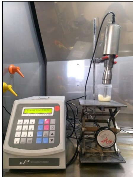
Fotografía 5 Aplicación de ultrasonidos de alta frecuencia al sistema
