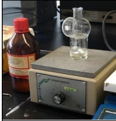
Fotografía 4 Adición del Sol de Silicio.
