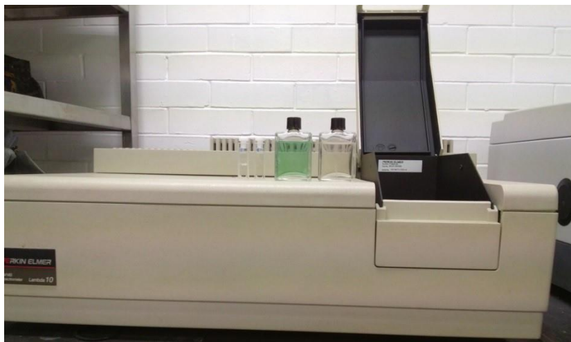
Fotografía 9 Espectrofotómetro UV-Vis, Modelo Lambda 10 de Perkin Elmer.
