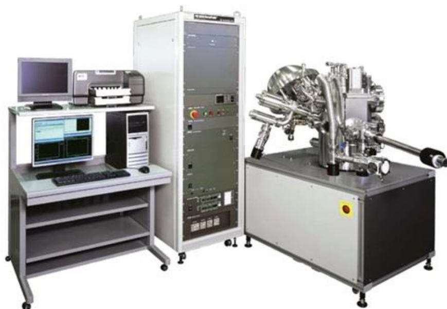
Figura 2.18: Fotografía de un espectrómetro de XPS PHI 5000 VersaProbe II.
