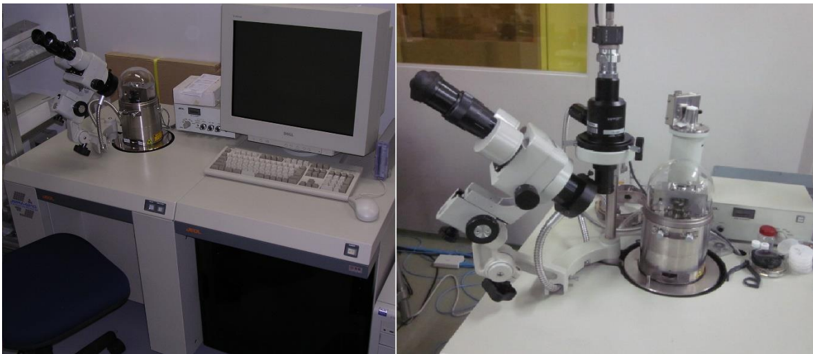
Figura 2.3: Imágenes del equipo de AFM marca Jeol, modelo JSPM-4210.
