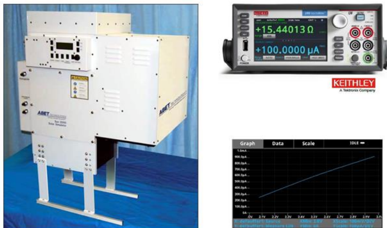
Figura 2.30: Equipos de medición experimental para la obtención de las curvas I-V
