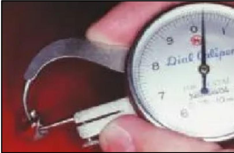
Figura 28. Calibrado de cofia metálica (Jr. Shillingburg, 2006)
