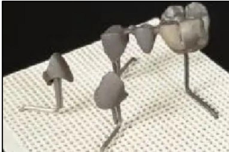
Figura 30. Subestructura de metal limpiada, antes de meterla al horno para oxidación. (Rosenstiel, 2009)
