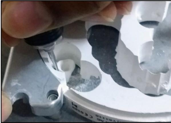
Figura 21. Retiro de disco de la fresadora y rescate de la corona del disco. Fuente: propia
