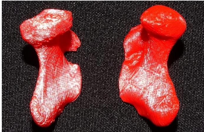
Fig. 4. Cóndilos impresos en 3D con PLA de paciente 3 (medición mediolateral)
