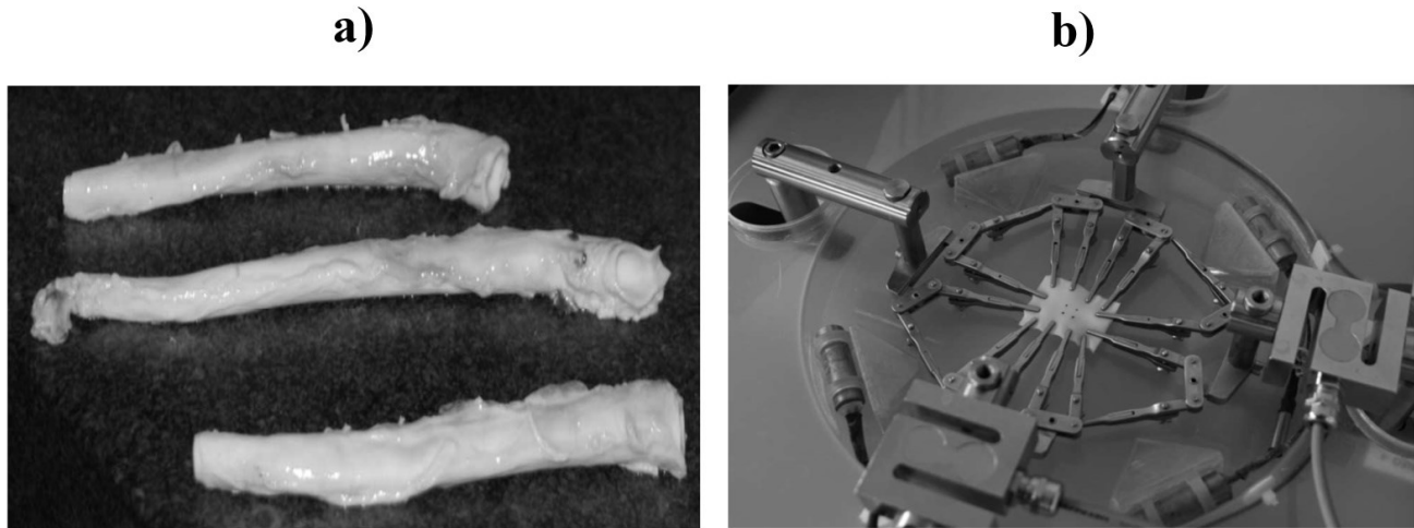
Fig. 4.1 Obtención de datos experimentales; a) Muestras de aorta torácico porcino; b) Muestra rectangular montada para el ensayo biaxial [121].
