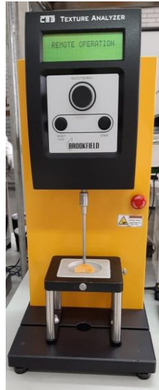
Figura 29. Texturómetro Brookfield CT3
