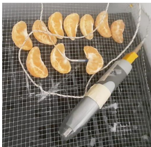
Figura 25. Monitoreo de temperatura en el centro del gajo de mandarina.
