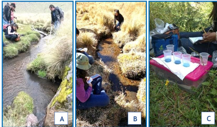
Figura 9. Determinación de propiedades de agua. A) establecimiento del perfil batimétrico, B) velocidad de corriente y C) cuantificación de alcalinidad.
