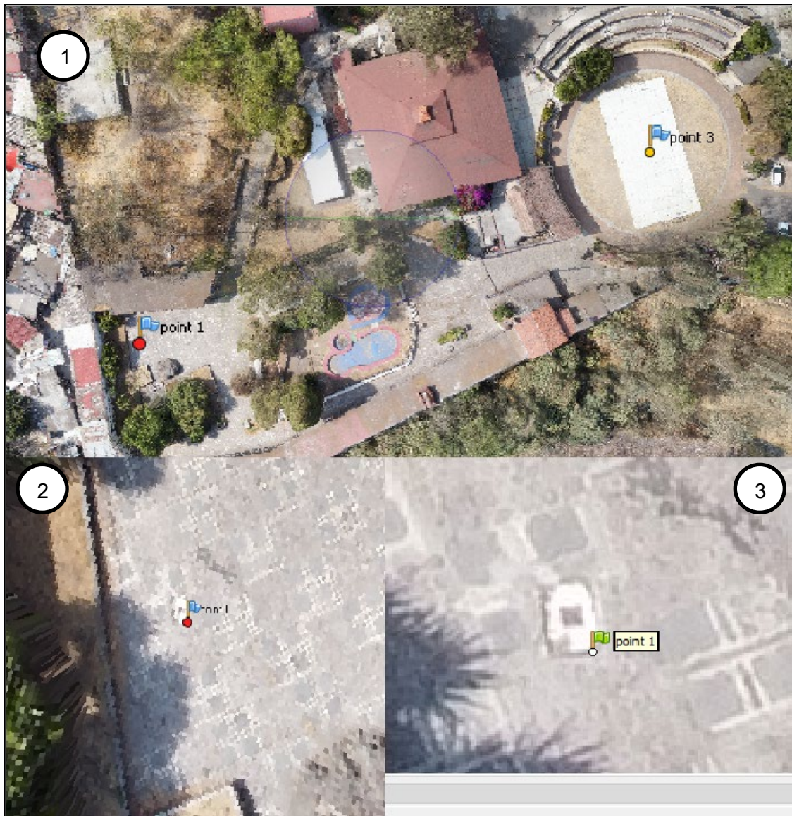
Imagen 36 En el recuadro 1 y 2 se colocaron los puntos de control en el terreno, en el recuadro 3 se ubica los puntos de control de forma precisa en cada una de las fotos que comparten el punto.
