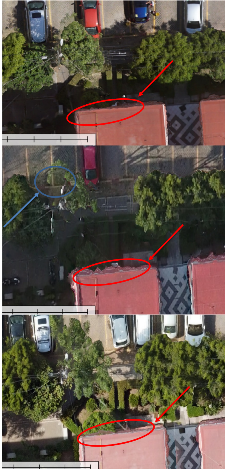
Imagen 40 La flecha roja se refiere a los errores tangenciales y la azul a las aberraciones por lente.
