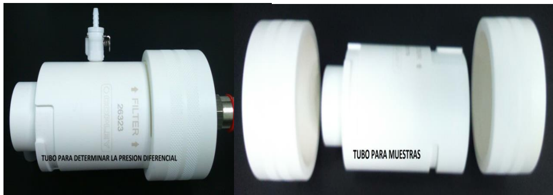
Figura 6. Tubos usados en la prueba del promedio y de la uniformidad de dosis liberada y determinación de presión diferencial.
