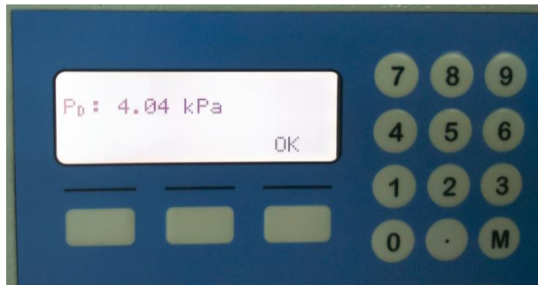
Figura 12. Vista del display cuando se ajusta la presión diferencial a 4.0 KPa.
