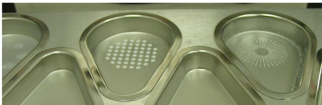
Figura 20. Vista de las cubetas del aparato impactador antes de la recuperación del activo.
