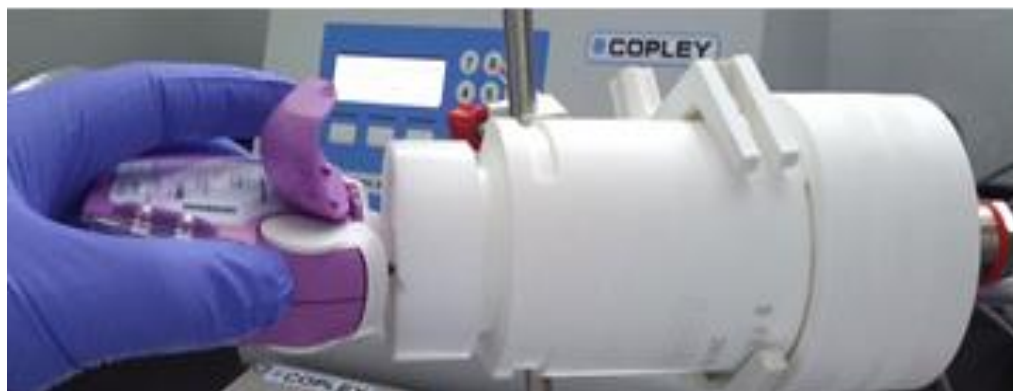
Figura 15. Extracción de muestra para determinación del promedio de dosis liberada y la uniformidad de dosis liberada.
