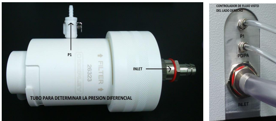
Figura 10. Conexión de tuberías entre el controlador de flujo y el tubo de presión diferencial para determinación de flujo de trabajo.
