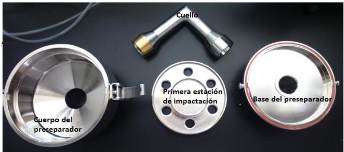
Figura 17. Partes del preseparador.
