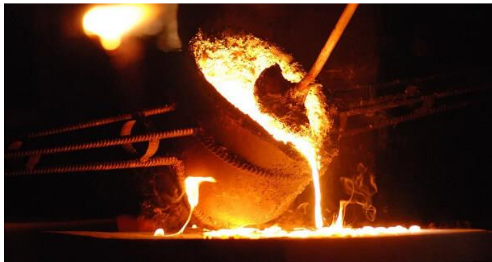
Figura 5.5 Los tornillos de banco de fundición emplean la técnica del colado sobre un molde (Tecnitool, 2021, “ https://tecnitool.es/ ”)
