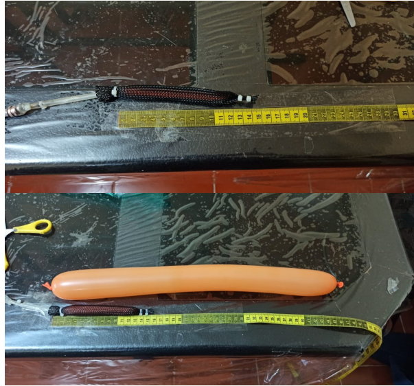
Figura 4.1: Fabricación de un músculo neumático McKibben
