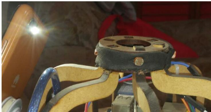
Figura 4.27. Aplicación de una alta incidencia de luz en el costado derecho del robot.
