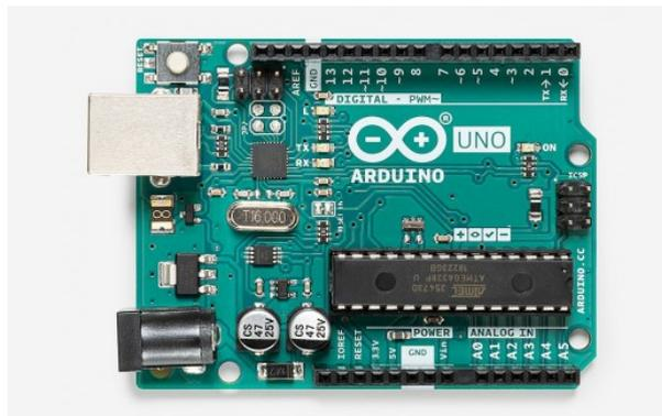
Figura 3.1. Placa Arduino UNO [6]
