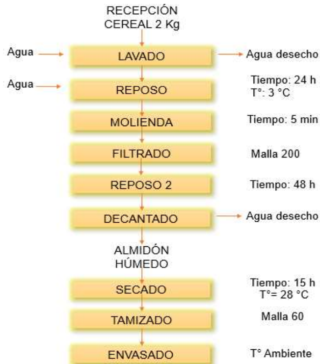
Fig. 2.1. Diagrama de bloques para la obtención del almidón.
