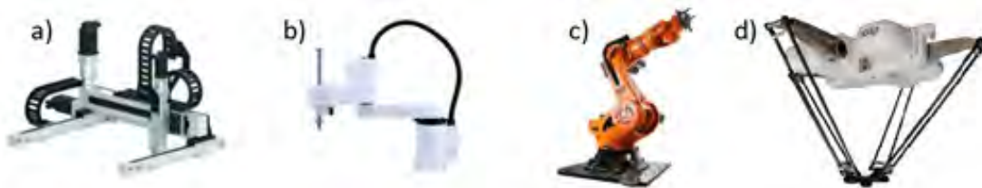
Figura 1.2.1 Algunos tipos de robots utilizados en la industria: de izquierda a derecha: a) cartesiano, b) SCARA, c) antropomórfico y d) delta. Obtenidas de [12, 13].
