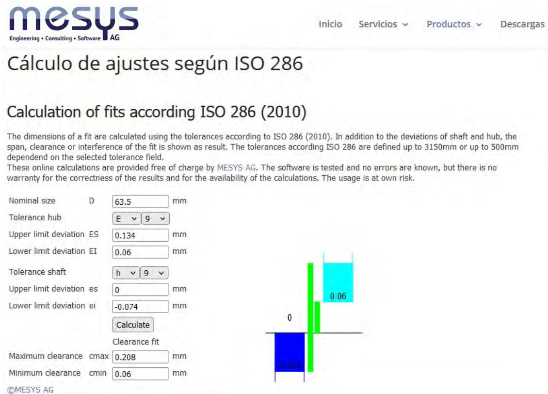
Figura 3.3.9. Cálculo de ajustes para el ensamble del motor con el brazo. Obtenida de [68].
