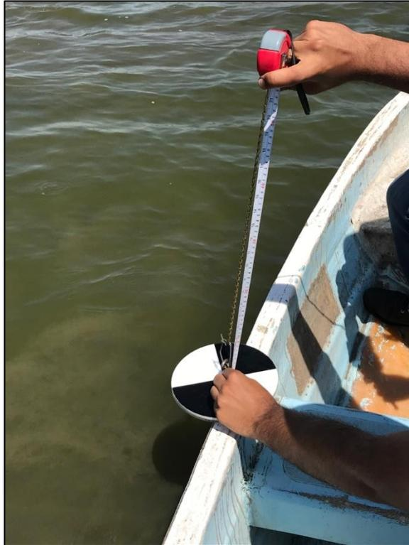
*Ilustración 7-2 Medición de transparencia con disco Secchi. Elaboración propia*
