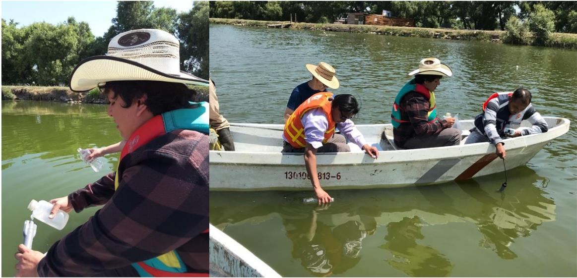
*Ilustración 11-1 Toma de parámetros de campo y muestreo en la Laguna de Zupitlán. Elaboración propia*
