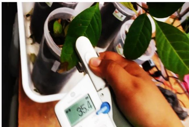
**Figura 22.** Registro de clorofila con el medidor automatico SPAD.
