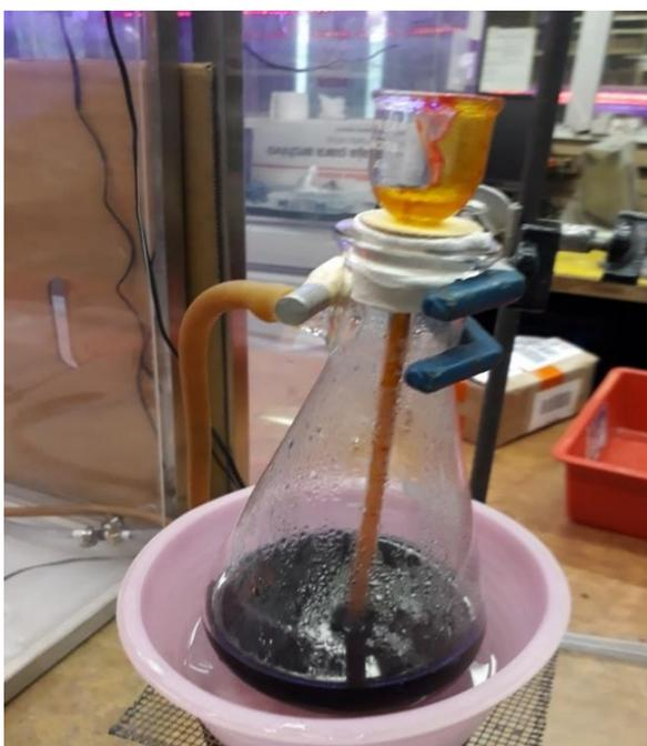
**Figura 21.** Reacción química para generar alumbre de cromo III con equipo para generar como producto al  $\text{SO}_2$ .
