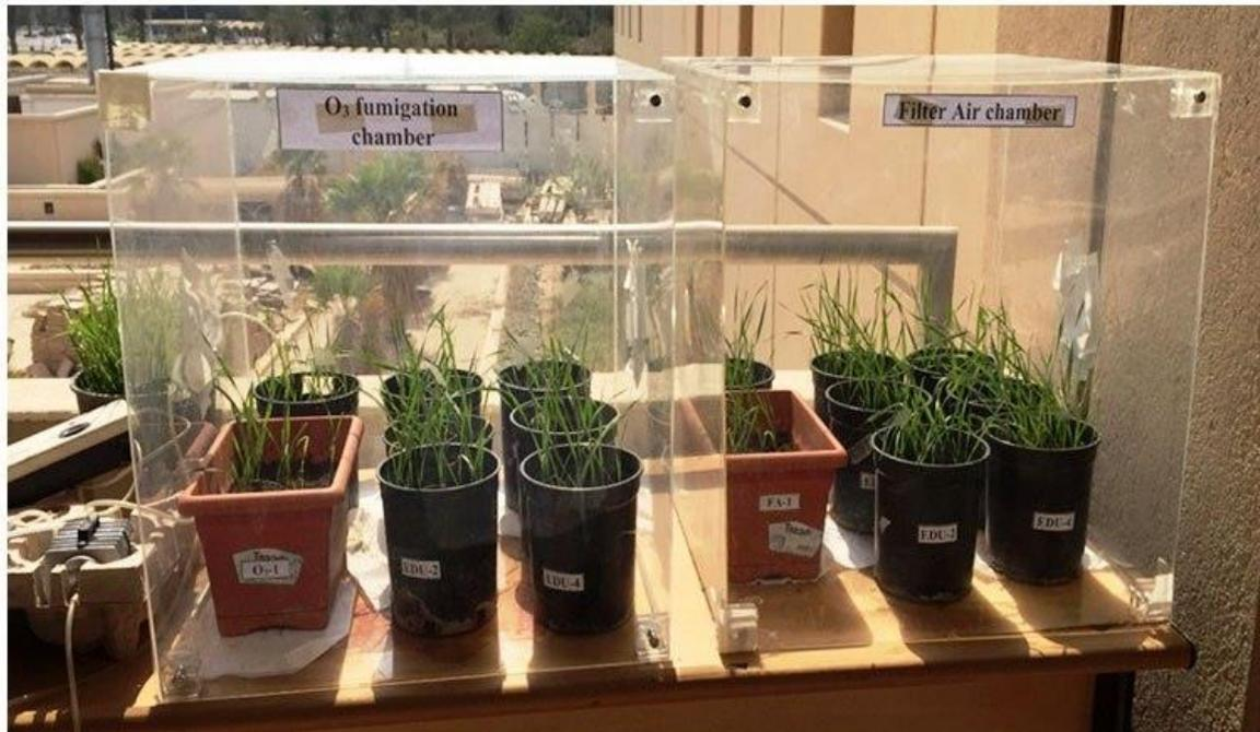
Figura 14. Cabina de fumigación a) Ozono, b) aire filtrado.
