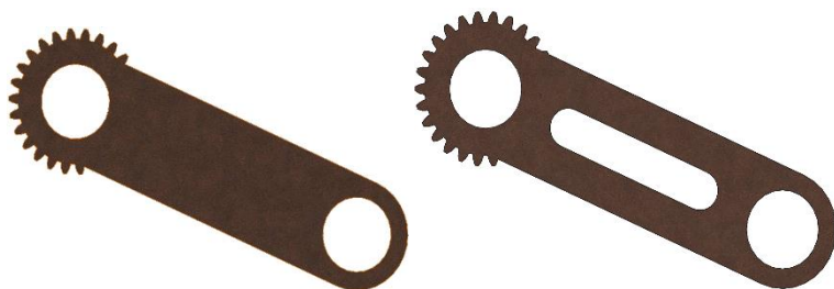
Figura 56. Engrane 4 Dedo meñique lado derecho sin optimizar, lado izquierdo con retiro de material. Elaboración propia mediante el software SolidWorks 2020 versión estudiantil.
