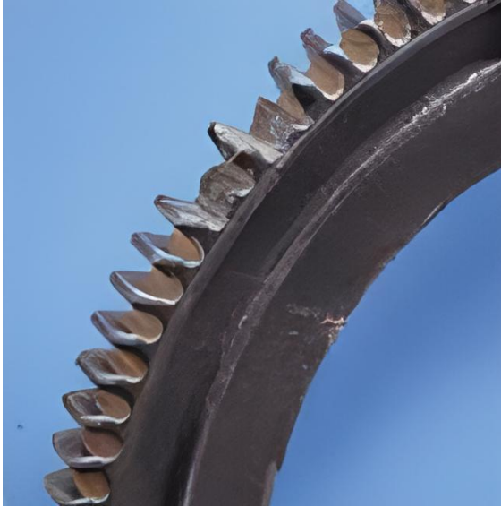
Figura 15. Fractura en el radio de entalle del engrane debido a sobrecargas [16].
