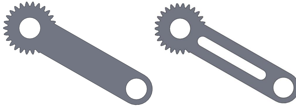
Figura 108. Engrane 4 sin retiro de material y con retiro de material dedo anular e índice. Elaboración propia mediante el software SolidWorks 2020 versión estudiantil.
