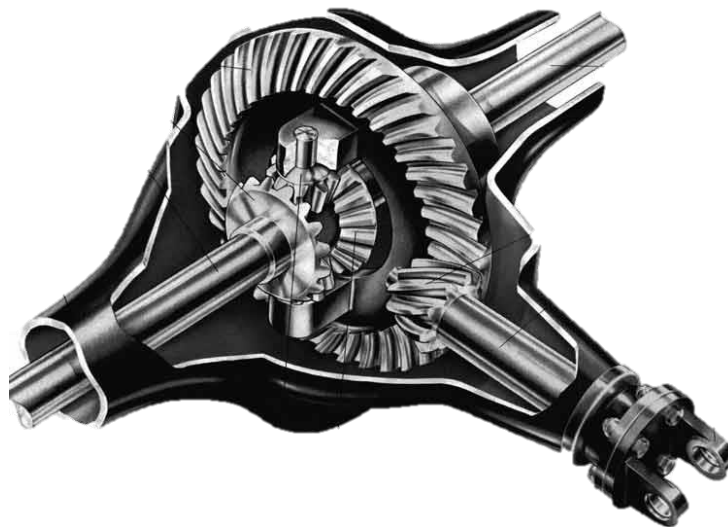
Figura 3. Transmisión diferencial para la tracción en los automóviles [9].
