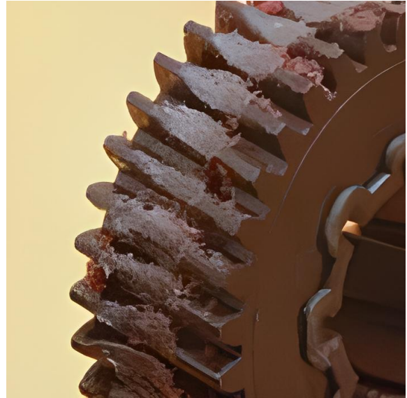
Figura 14. Deformación del diente debido al calor excesivo [16].
