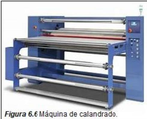
Al final del equipo extrusor se coloca *un dado plano o boquilla plana* que produce una película de plástico que se hace pasar por un juego de rodillos, mismos que le darán las características de grosor “cédula”, anchura, y modelo finales. Mediante el calandrado se obtienen principalmente rollos, sin embargo cuándo la cedula de la película es grande o si
