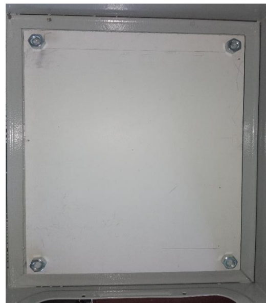
Ilustración 47 - Ensamble de la base del gabinete
