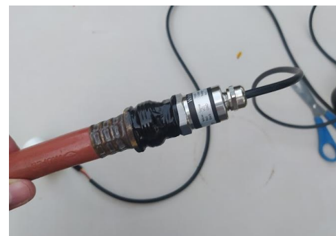
Ilustración 79 - Evidencia prueba del sensor de presión
