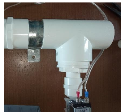
Ilustración 55 - Ensamble de la válvula de entrada
