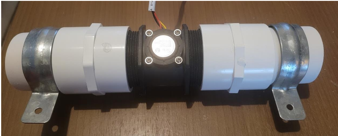
Ilustración 54 - Ensamble del sensor de caudal
