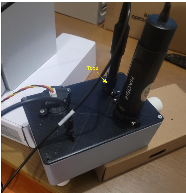
Ilustración 72 - Ajuste de sujeción de la probeta del sensor de oxígeno disuelto
