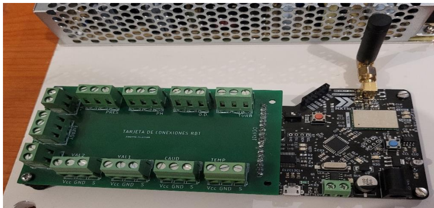
Ilustración 48 - Ensamble de la tarjeta de conexiones y la tarjeta de control
