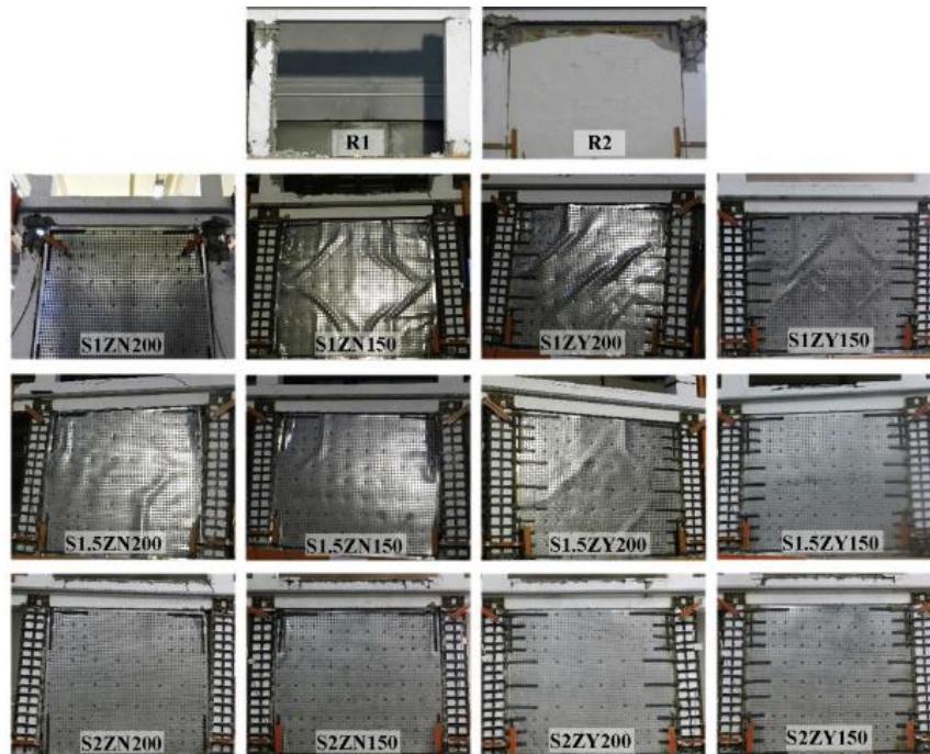
Figura 43. Modos de falla de los especímenes ensayados (Özbek, et al., 2019).
