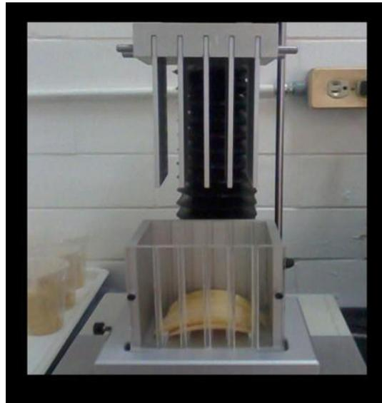
Figura 8. Vista lateral del sistema de medición de textura TA.XT2 en el método de corte (*iCrispness*) utilizando sonda Kramer. Autor: Ramírez Tapia.
