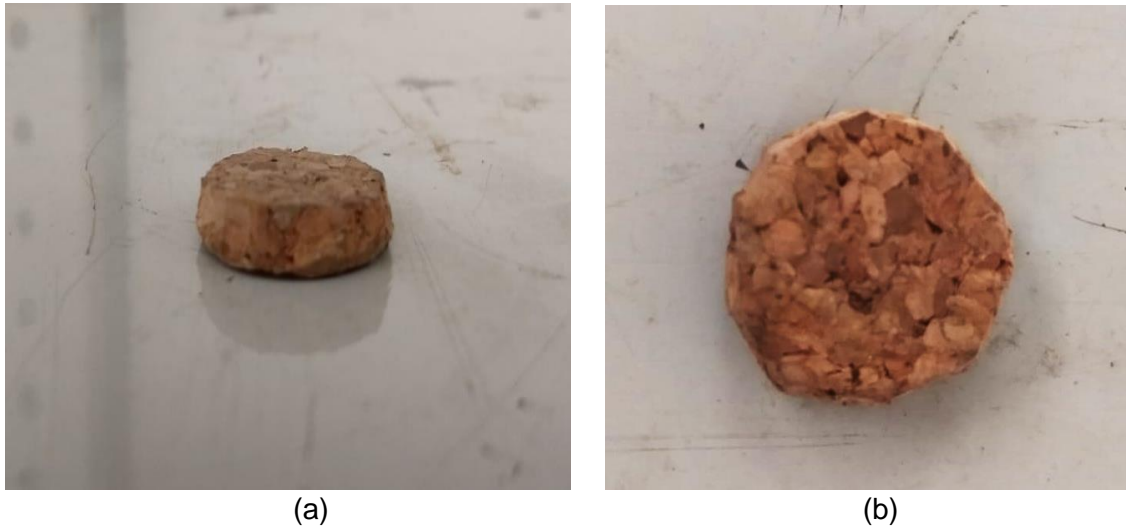
Figura 3.3 Corcho utilizado como membrana final, (a) altura del corcho 6 mm (b) cara del corcho frontal
