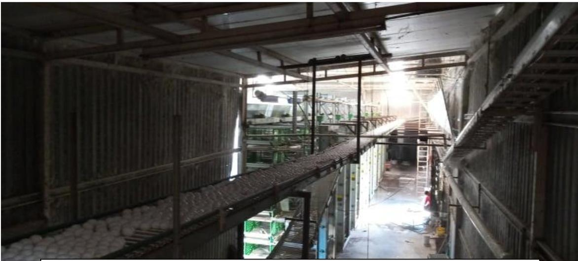
Figura 10. Línea de transporte de huevo de jaulas hacia área de empaquetado
