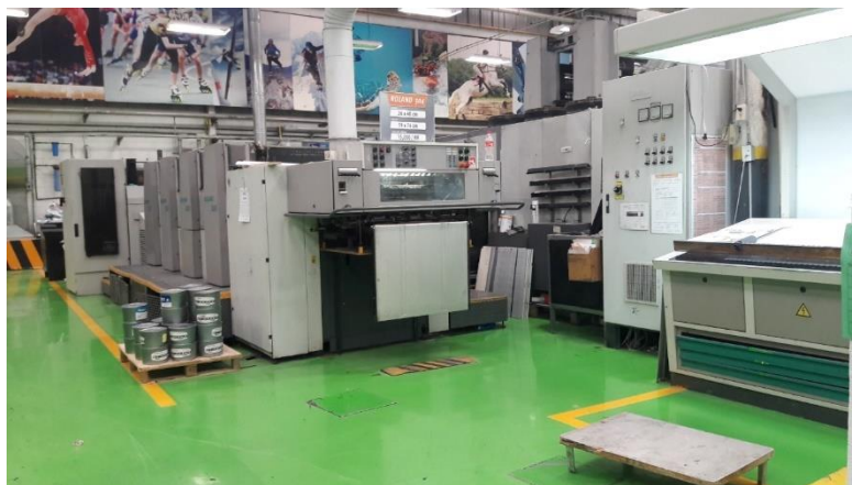
Ilustración 8- Impresora Man Roland 304 (Argo Artes Gráficas S.A.).
