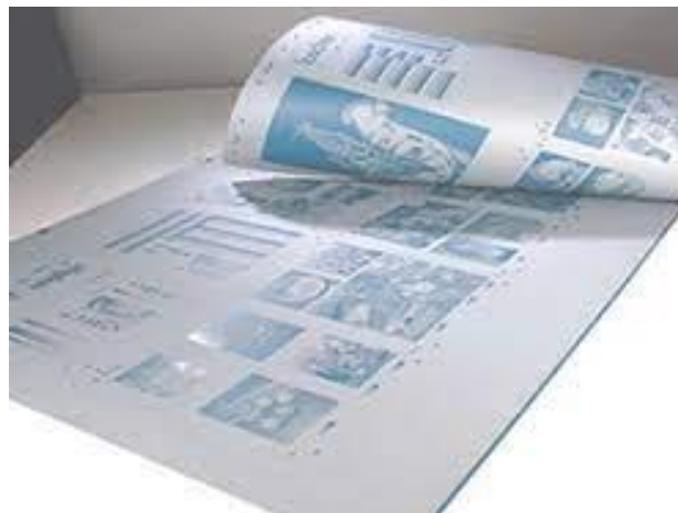
Ilustración 28- Placa litográfica de aluminio (Argo Artes Gráficas S.A.).
