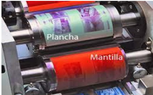
Ilustración 27-Mantilla de caucho colocada sobre rodillo giratorio (Argo Artes Gráficas S.A.)
