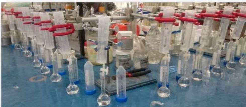
*Figura 6.4 Paso final de la extracción. Elución de los metales intercambiados por la resina Chelex 100. Enrace a 25.0 mL con  $\text{HNO}_3$  2M*
