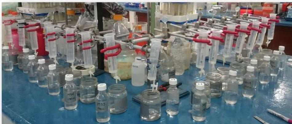
*Figura 6.3 Sistema montado para la extracción de metales en agua con alta salinidad por intercambio con resina Chelex*
