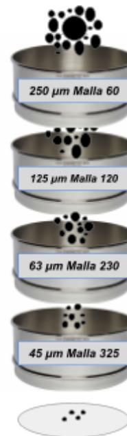
Figura 3.2-1: Arreglo de Tamices usado durante la experimentación.
