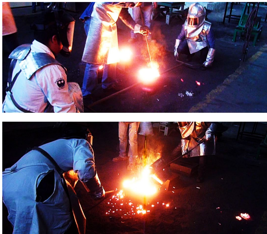
Figura 3. 7. Operación de vaciado de acero CP líquido en los moldes de arena.
