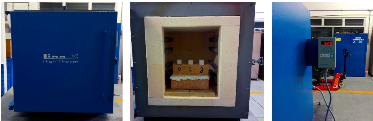
Figura 3. 19. Vista frontal de la mufla utilizada y arreglo de las probetas de acero CP dentro del horno de homogenizado.
