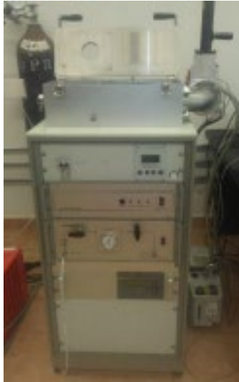
Figura 3. 22. Curva para el diseño para el tratamiento térmico de Q&P Dilatómetro de Temple LINSEIS-RITA L78.
