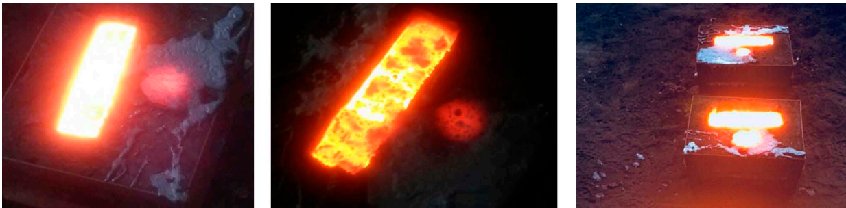
Figura 3. 8. Lingotes solidificando después de vaciado B0 y B3.
