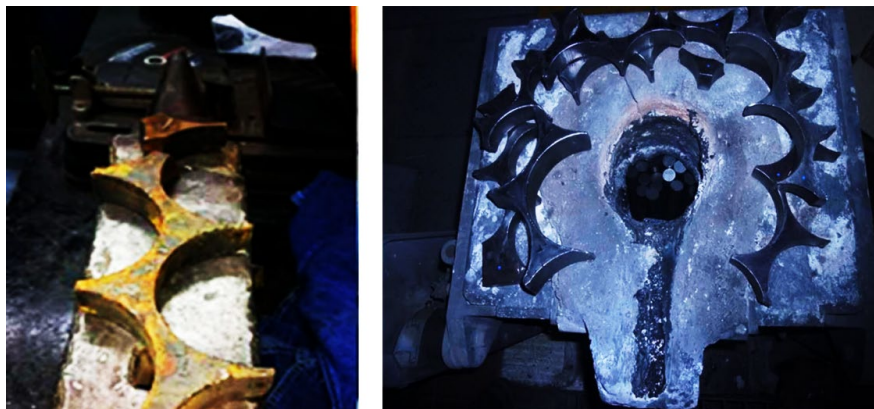
Figura 3.2. Chatarra de acero estructural utilizada en el proceso de fabricación del acero CP: a) Sin limpiar, con capa gruesa de óxido y b) Con limpieza, eliminación de capa de óxido.
