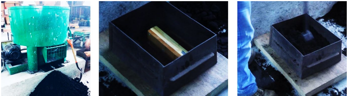
Figura 3.3. Molino chileno donde se hizo la mezcla de la arena, agua, aglutinantes y bentonita activa.
