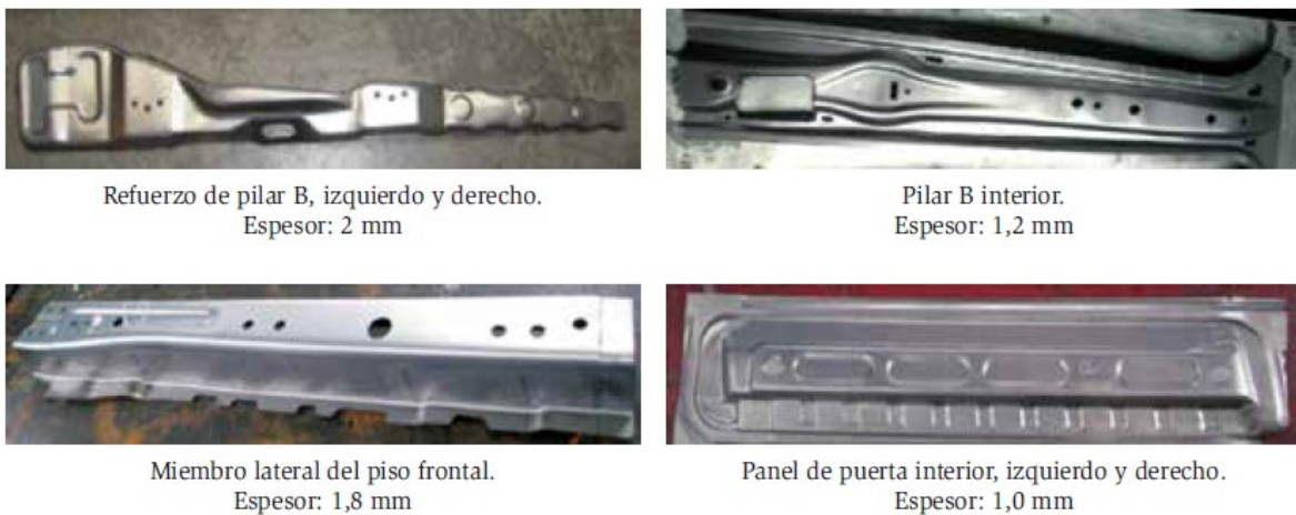
Figura 2.16. Partes estructurales de automóviles producidas con acero de temple y partición [59].
