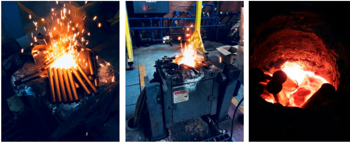
Figura 3.5. a-b) Vista del horno de inducción y c) Carga en proceso de fusión.
