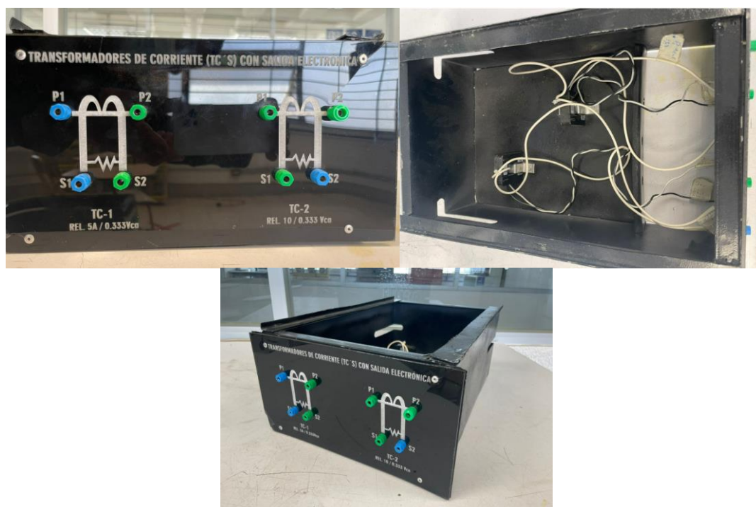
Figura 3.7A Transformadores de corriente (TC'S) con salida electrónica
