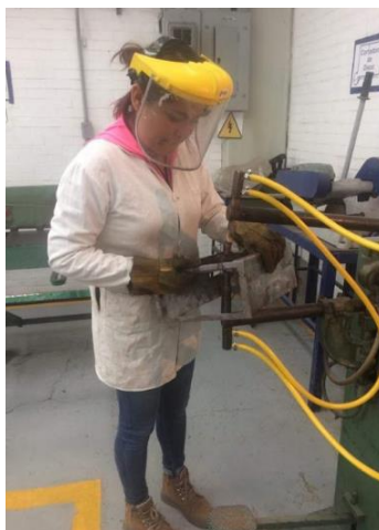
Figura 3.3G Unir las partes con soldadura de punto.
