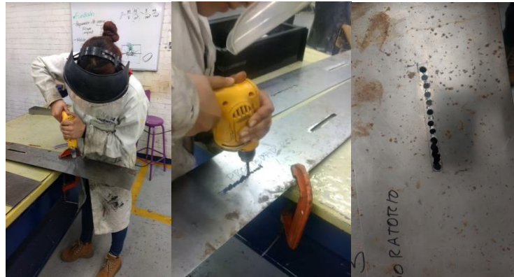
Figura 3.3B Perforado de lámina para crear los orificios propios del diseño del módulo.
