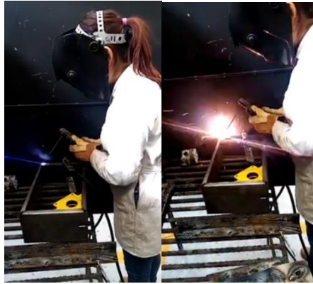
Figura 3.3J Reforzando la soldadura en el ángulo
