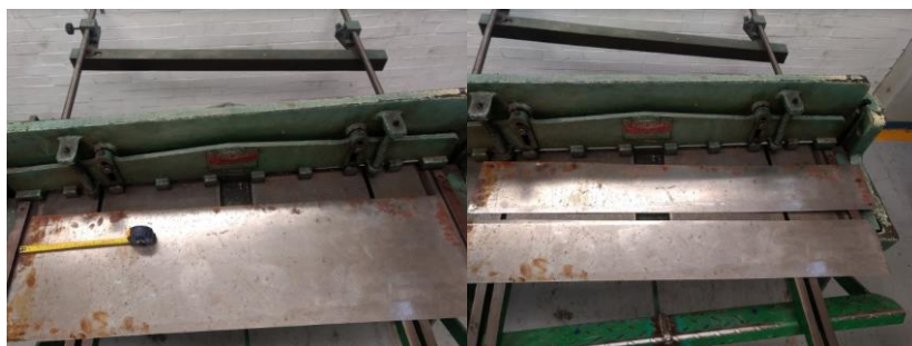
Figura 3.3A Corte de lámina para obtener las piezas que le darán forma al módulo.
