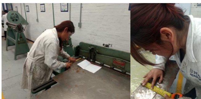
Figura 3.3 Trazo de las medidas que se utilizarán para la elaboración de 2 módulos idénticos.
