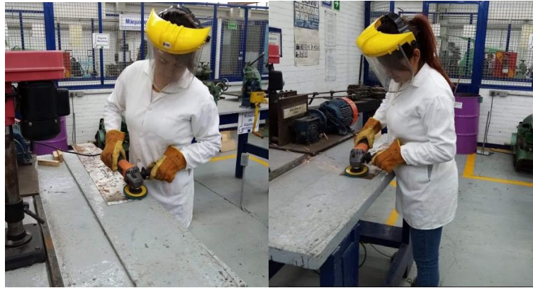
Figura 3.3D Proceso de lijar las láminas.
