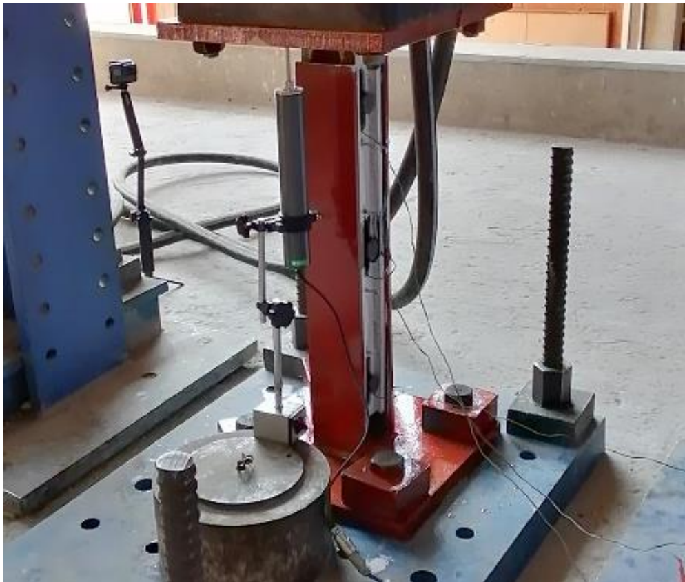
Figura 18. Imagen de disipador prototipo para prueba de laboratorio.
