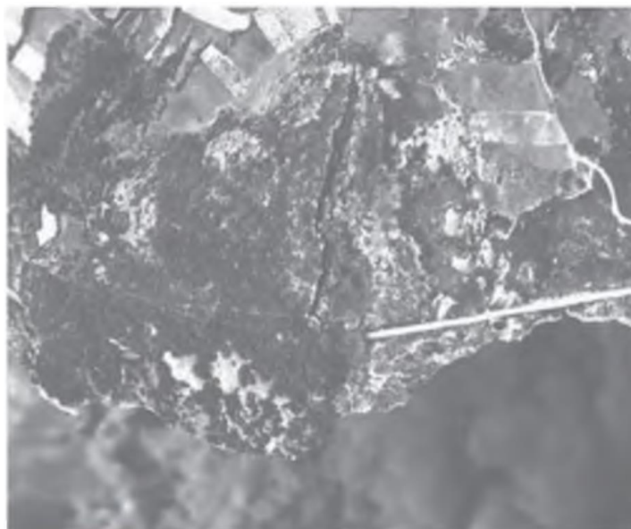
Figura 30. Línea férrea Palenda-La Coruña afectada por deslizamientos y agrietamientos kársticos; escala 1/4.000 (González de Vallejo, 2002).
