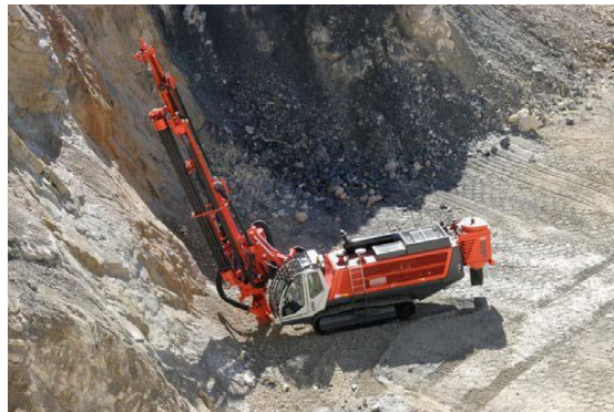
Figura 35. Sistema a rotopercusión (Castilla y Herrera, 2012)
