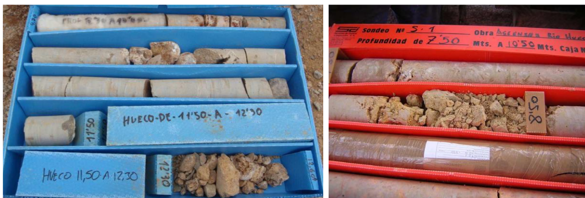
Figura 31. Caja de sondeo a) calizas sin relleno b) calizas con relleno arenoso (Pinillos, 2015)
