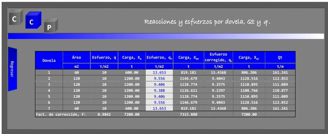
Figura 85.1-b. Ventana **Reacciones y esfuerzos por dovela  $Q_t$  y  $q$ .** [Elaboración propia].
