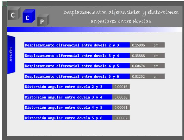
Figura 96. Ventana Desplazamientos diferenciales y distorsiones angulares entre dovelas [Elaboración propia].
