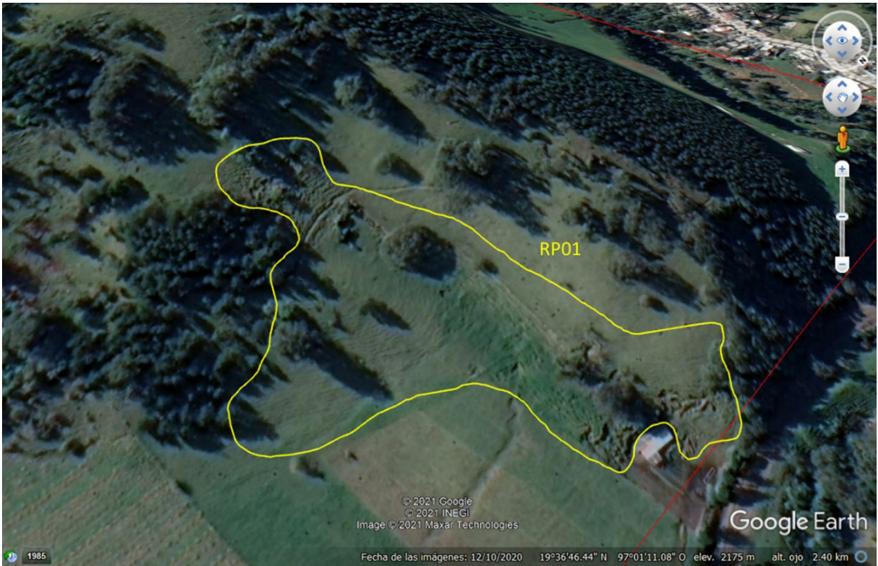
Figura 58. Zona de reptación RP01 limitada en color amarillo, en la ladera norte del cono de ceniza Cerro del Cajete. Obsérvese en la base de la zona de reptación una vivienda y la línea del ferrocarril y, en la esquina superior derecha de la figura, la localidad La Joya. Imagen satelital descargada de Google Earth Pro. Fecha de la imagen: 12 de diciembre de 2020
