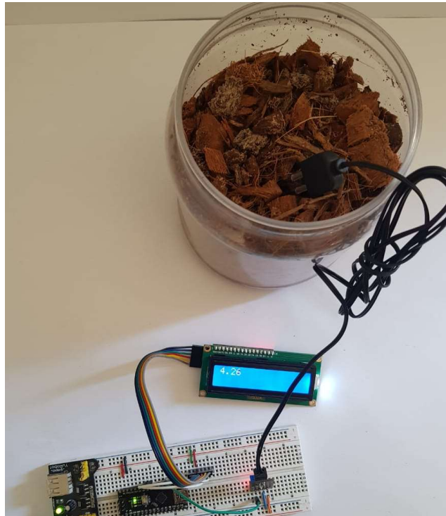
Ilustración 4-22 Prueba con higrómetro FC-28.
