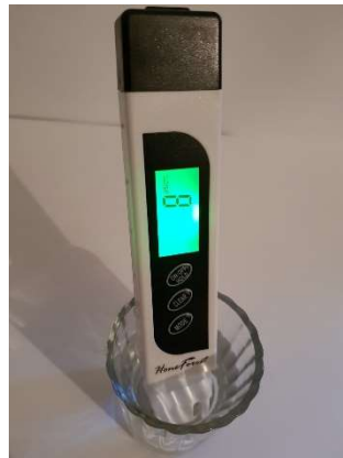
Ilustración 4-10 Prueba de conductividad para agua destilada (8uS/cm).
