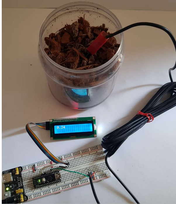
Ilustración 4-24 Prueba con sensor VH400.
