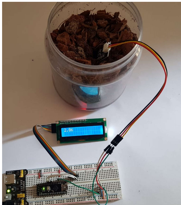
Ilustración 4-23 Prueba con sensor capacitivo.
