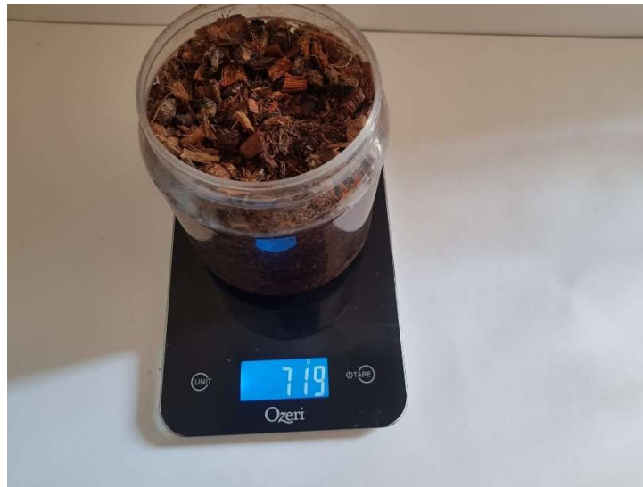
Ilustración 4-19 Peso del agua para saturación de la muestra.
