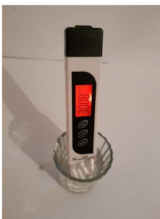
Ilustración 4-12 Prueba de conductividad para la muestra de agua 2 (3008uS/cm).
