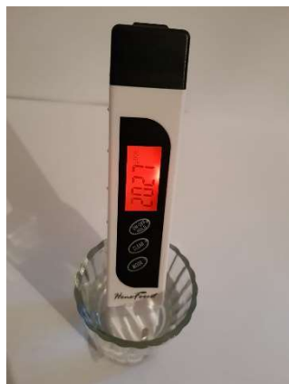
Ilustración 4-11 Prueba de conductividad para la muestra de agua 1 (2027uS/cm).
