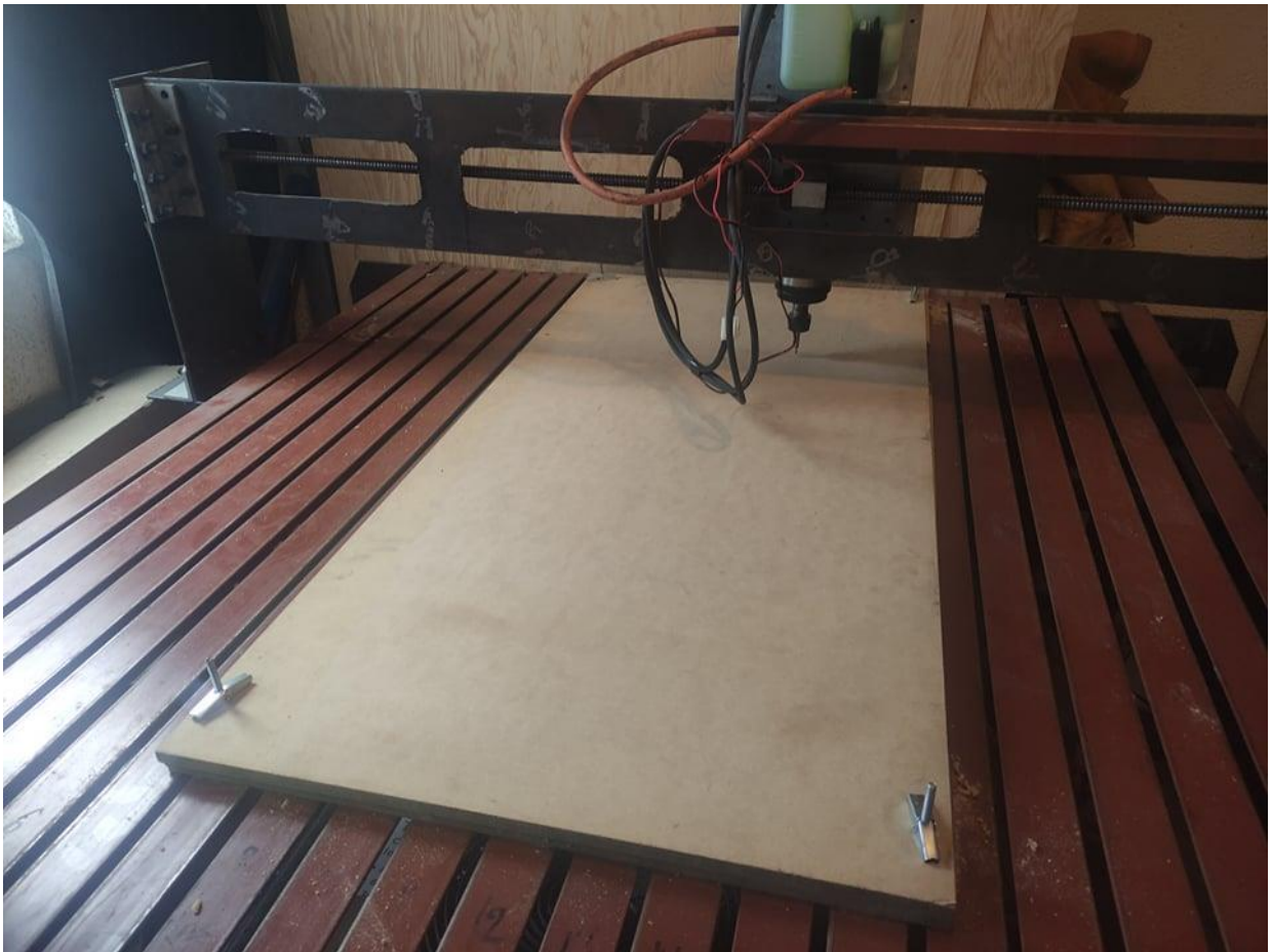
Figura 7.1. Colocación del tocho.
