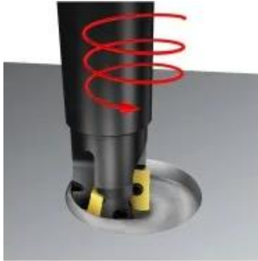
Figura 1.9. Mecanizado de rampa circular.
